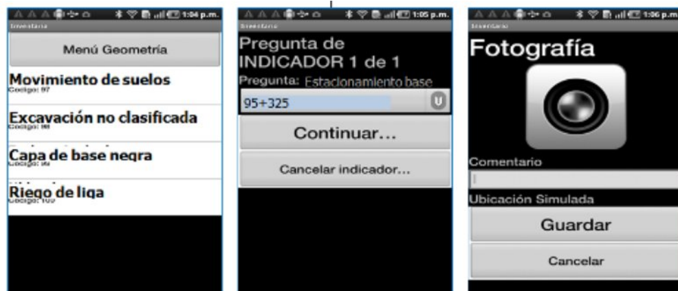
Figura 3: Pantallas utilizadas para registrar las cantidades ejecutadas en la obra
