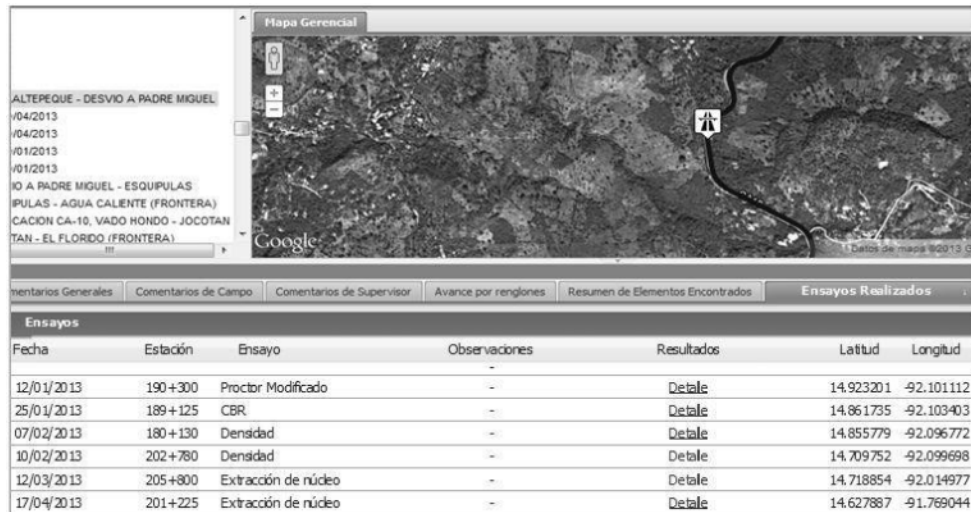
Figura 6: Registro de ubicación de pruebas de laboratorio en campo
